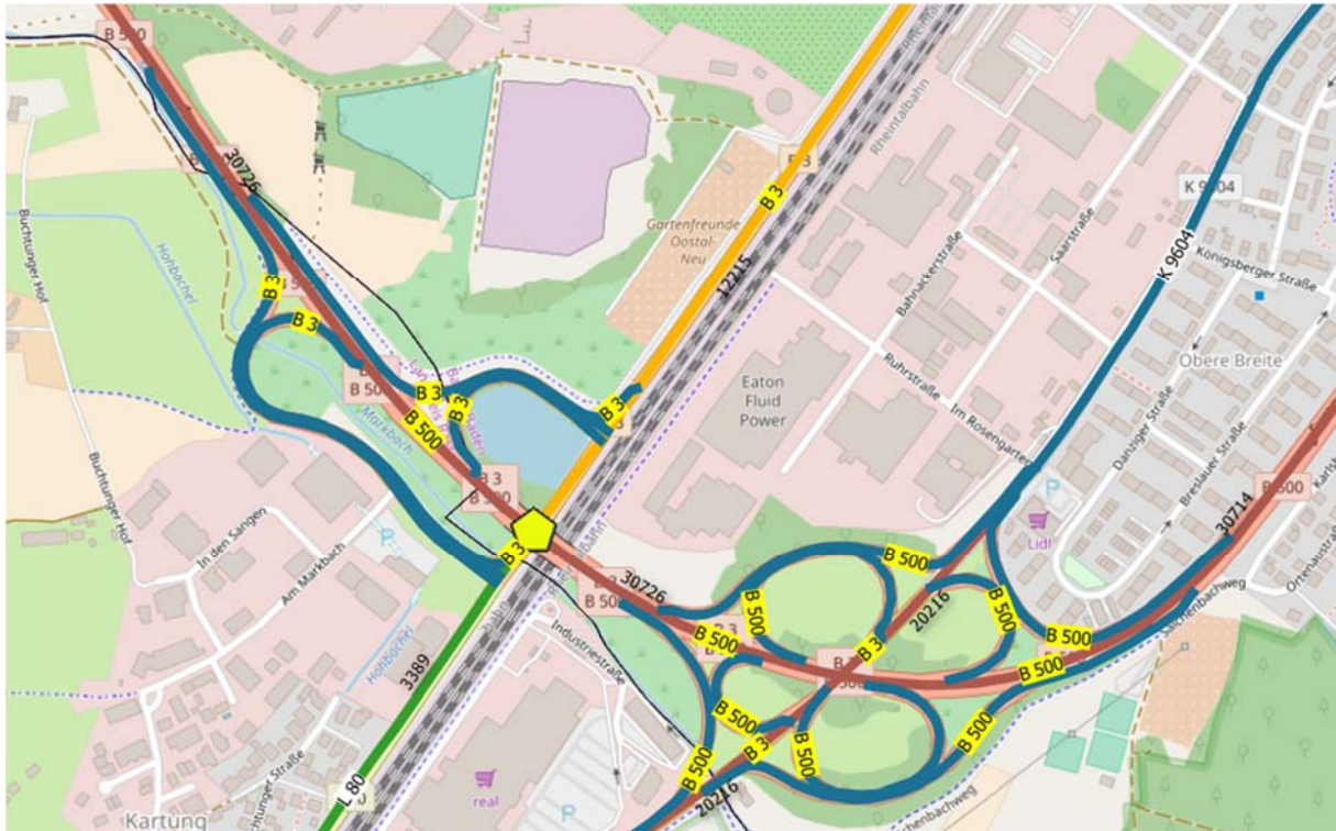
Abb. 6-9: DTV-Wechsel an Kreisgrenze mit Kreuzung (Bsp. Netzknoten 7215059 bei Hartung)
